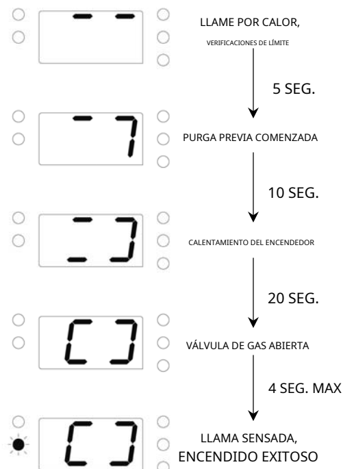
Figura 24: Pantalla de secuencia de encendido
