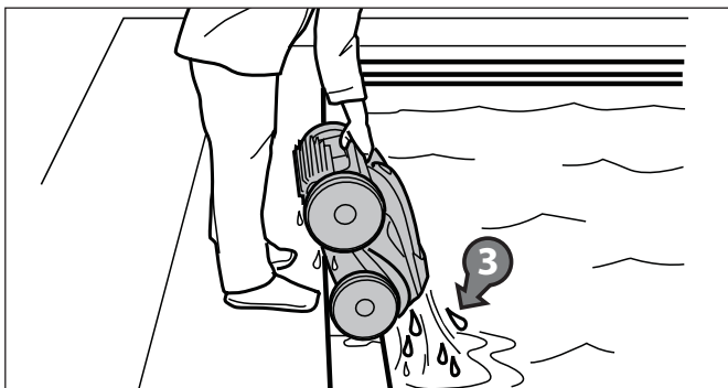
Figura 19. Mantenga le limpiafondos verticalmente para drenarlo de agua
