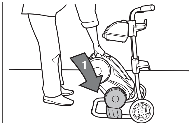
Figura 25. Coloque el limpiafondos en el carrito
